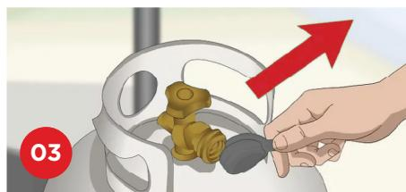
Na novi polni jeklenki odstranite Butan plin varnostno folijo in plastični pokrovček.
