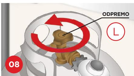
Odprite ventil na jeklenki. Slišali boste kratek pisk plina.
