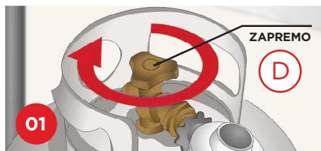
Zaprite ventil na jeklenki.
